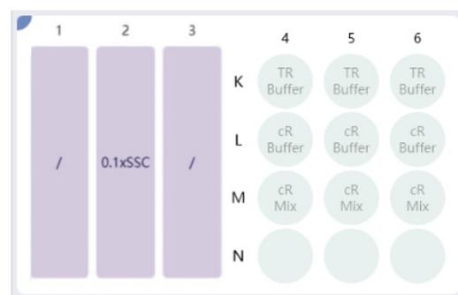
图 2-7 常温试剂台面放置示意图
