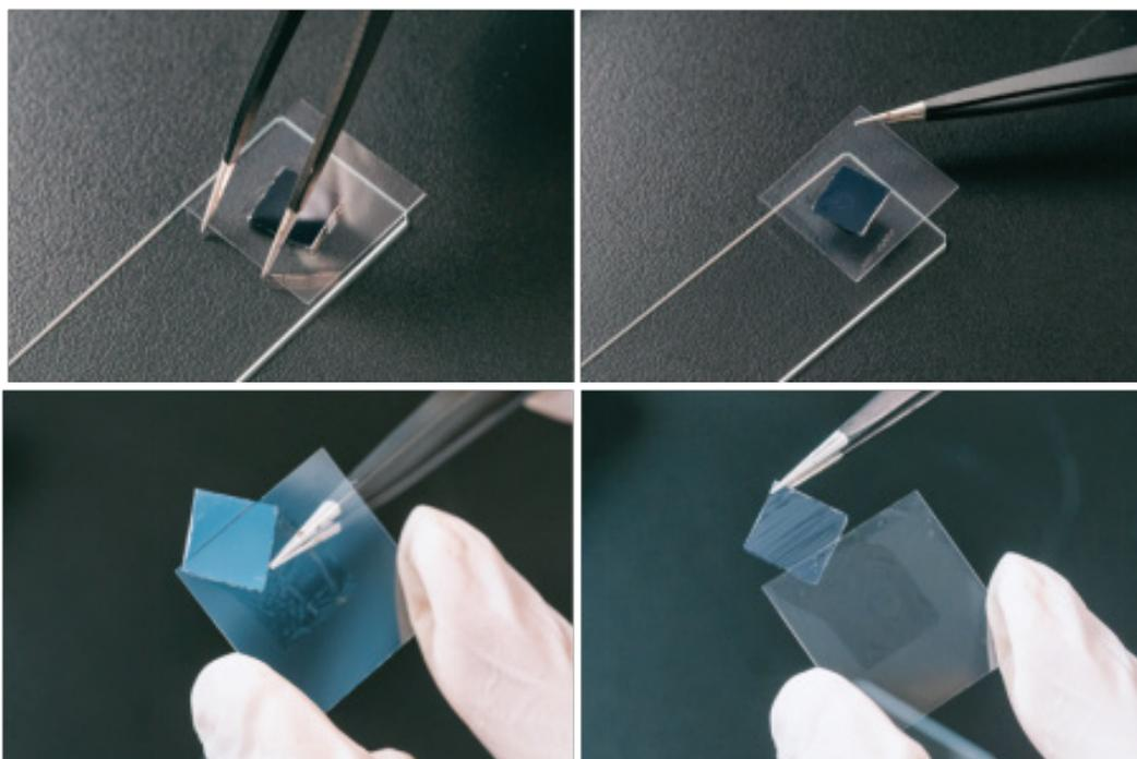
c. 在干净的芯片容器单孔中央加 3  $\mu\text{L}$  左右甘油，将芯片平放至芯片容器中央。请按照透化时间“由短至长”的顺序放置第 1-8 孔的芯片（细节请见（3）程序信息录入的步骤 b）。
